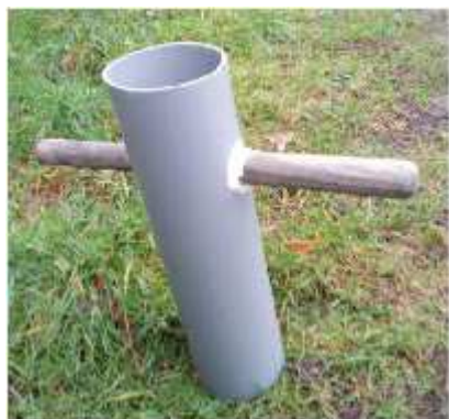
Carottier : surface échantillonnée de 135 cm 2 . Épuisette : échantillonnage sur 360 cm 2 .
